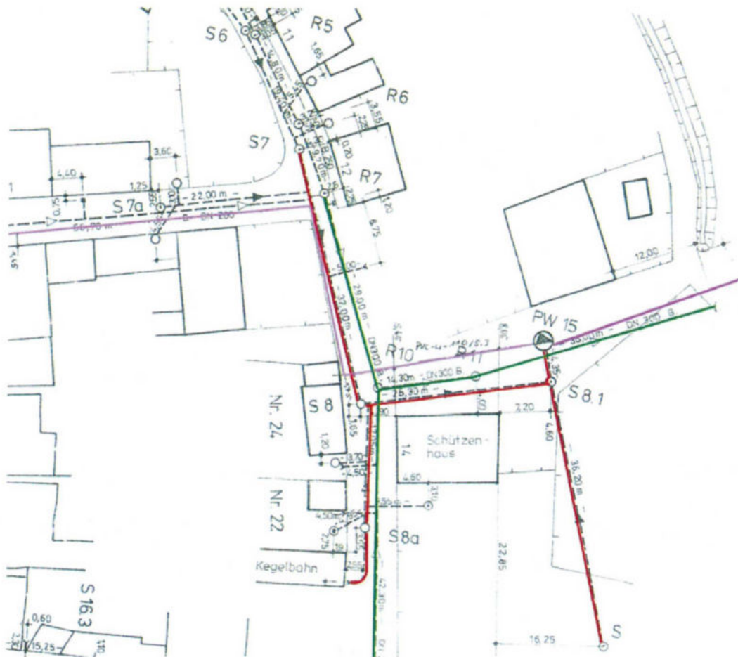
Abb.: vorhandene Schmutz- und Regenwasserleitungen (unmaßstäblich)
